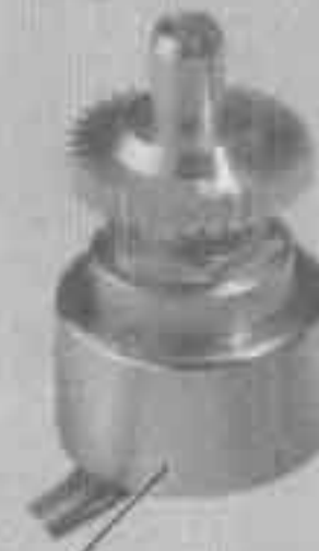
پتانسیومتر یا چرخنده لغزنده روی محور
